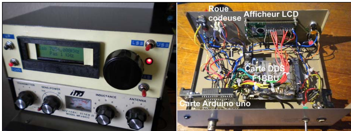
Figure 7. "Le coffret VFO à DDS (sur ma boîte d'accord antenne) et l'intérieur"
