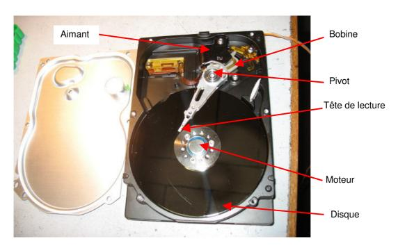
Le moteur qui fait tourner le plateau est un modèle triphasé, le plus souvent. C'est un circuit intégré spécialisé qui génère les tensions nécessaires pour chaque enroulement.
